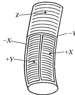
Рис.3. Тонкостенная трубка из пьезокерамики обеспечивает перемещение иглы по трем координатам. Для этого на трубке нанесены металлические электроды. При приложении напряжения к парам электродов  $-X, +X$  или  $-Y, +Y$  трубка изгибается, и игла перемещается по координатам X и Y. Подача напряжения к Z-электроду приводит к изменению общей длины трубки — игла перемещается по координате Z
