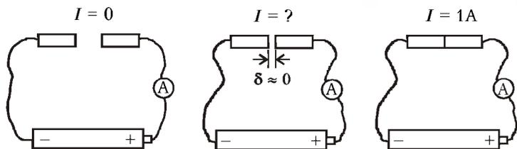
Рис.1. При большом зазоре между проводниками ток равен нулю, при контакте проводников в цепи течет ток, например 1 А. До какого расстояния  $\delta$  нужно сблизить два проводника, чтобы появился заметный электрический ток?
