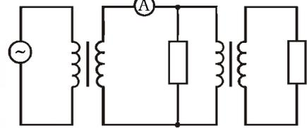
Тут возможны четыре различные схемы подключения обмоток трансформаторов: 1) оба трансформатора понижающие, 2) оба повышающие, 3) первый понижающий, второй повышающий и 4) первый повышающий, второй понижающий. В случае 1) напряжение на первом резисторе 110 В, на втором 55 В. Ток через амперметр совсем просто найти из энергетических соображений:
