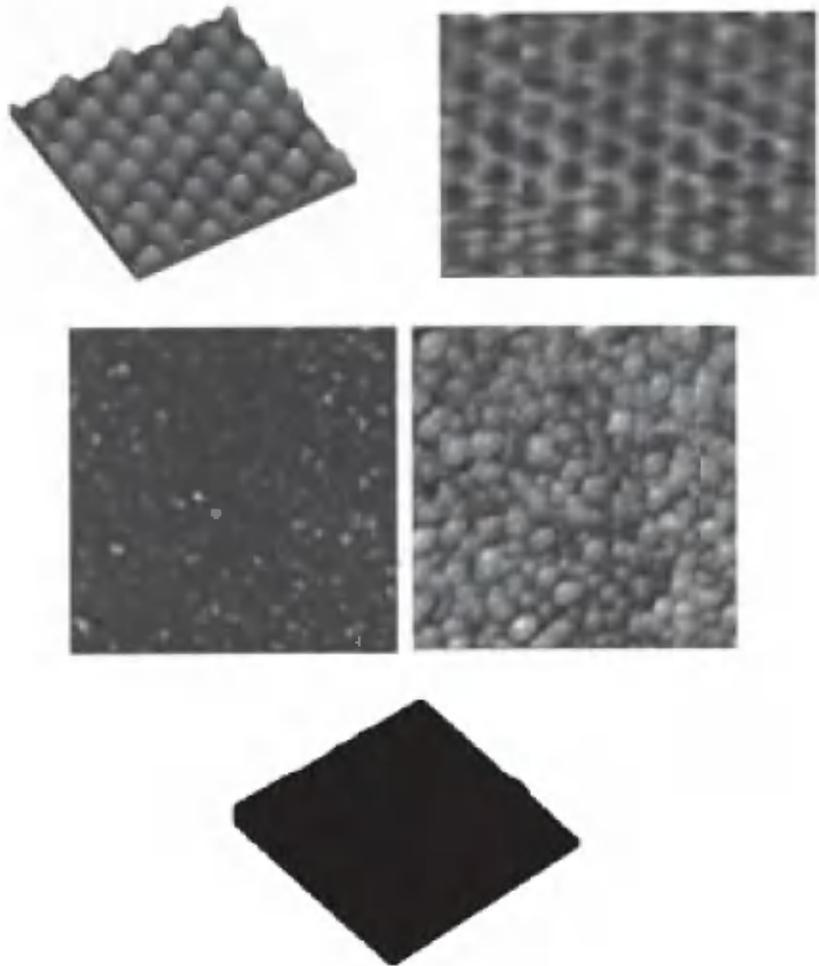
Рис.4. STM позволяет увидеть отдельные атомы на различных проводящих поверхностях. На рисунке сверху изображены поверхности графита (площадью  $1,7 \times 1,7$  нм) – слева, и сульфида молибдена ( $2,4 \times 2,4$  нм) – справа.
