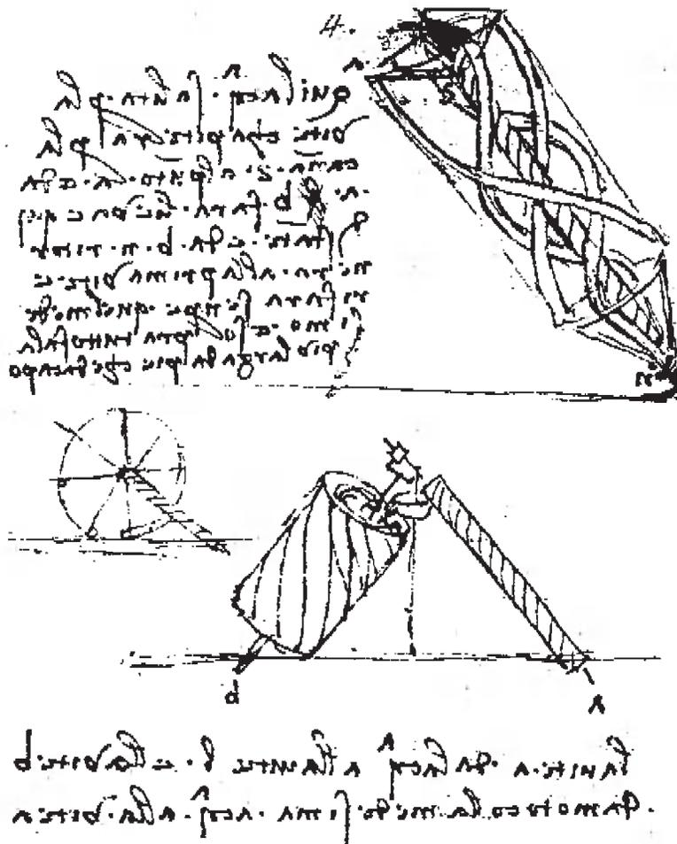
Рис. 3. Схемы вечного двигателя на основе винта Архимеда
