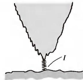
Рис.6. Игла неправильной формы – обычно один атом находится к поверхности чуть ближе, чем все остальные
